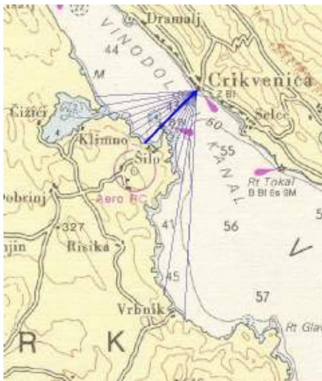
Tablica 3::III i Slika 3:2 Proračun dužine privjetrišta za valove iz SW smjera
