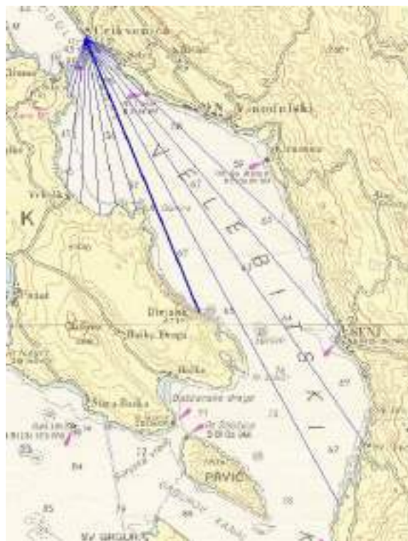
Tablica 3::II i Slika 3.1 Proračun dužine privjetrišta za valove iz SSE smjera
