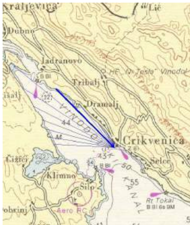
Tablica 3::V i Slika 3.4 Proračun dužine privjetrišta za valove iz NW smjera
