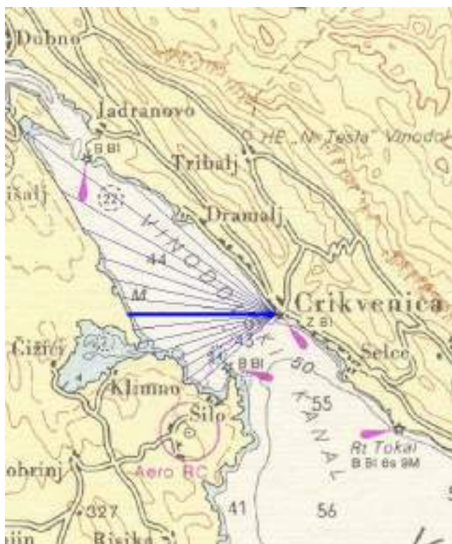
Tablica 3::IV i Slika 3.3 Proračun dužine privjetrišta za valove iz W smjera
