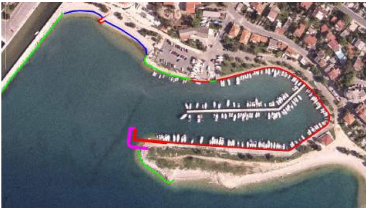
Slika 3::27 Koeficijenti refleksije - postojeće: crveno 0,90; zeleno 0,35; plavo 0,20, - projektirano: ljubičasto 0,35; crveno 0,90;
