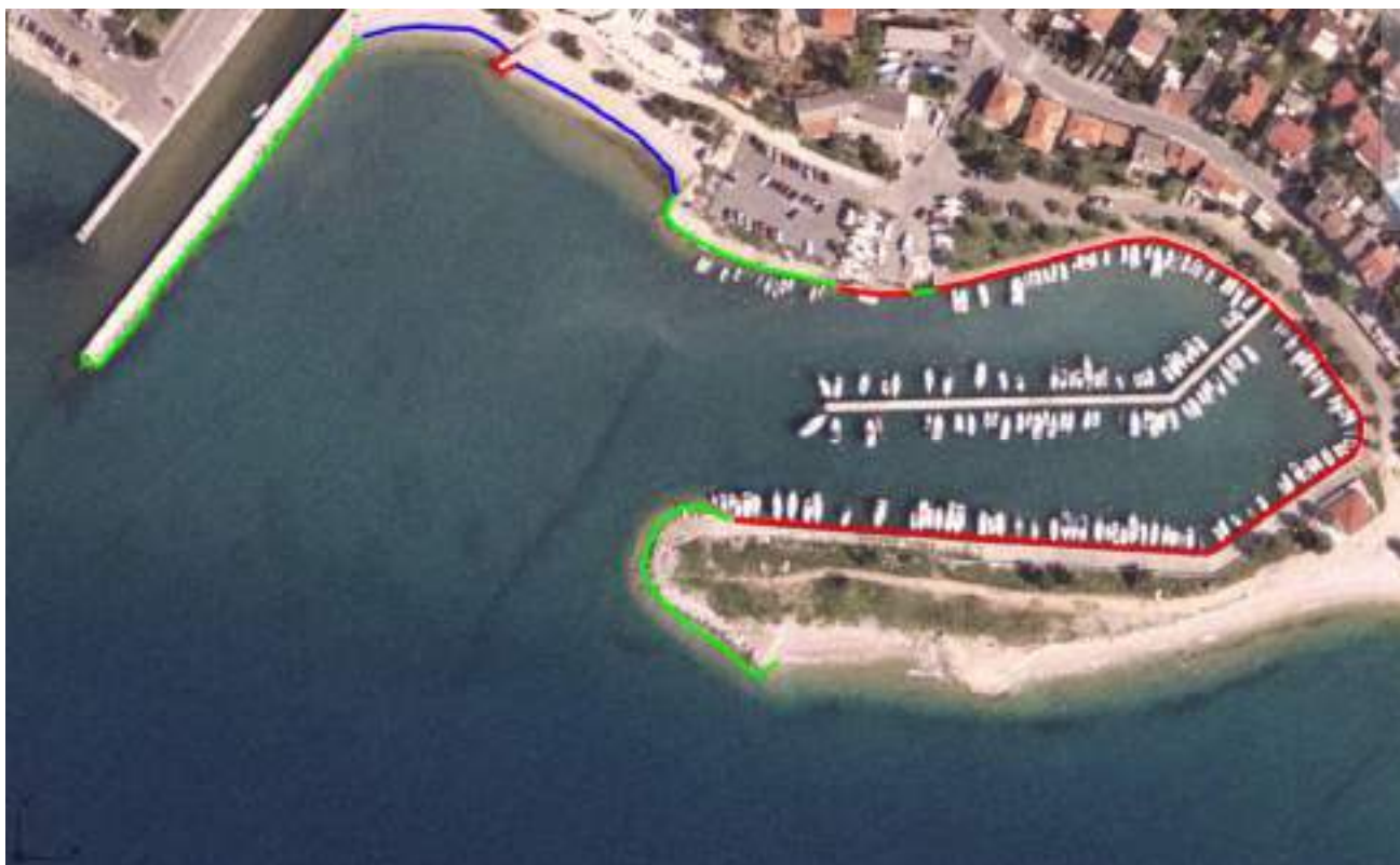
Slika 3::21 Postojeće stanje, koeficijenti refleksije: crveno 0,90; zeleno 0,35; plavo 0,20
